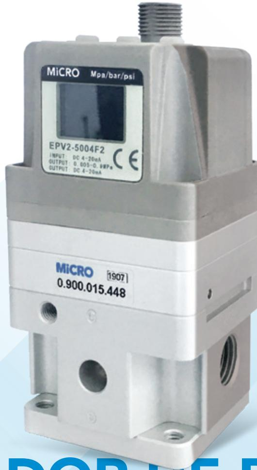
**El regulador de presión proporcional controlado electrónicamente actúa instantáneamente, regulando la presión de la vena fluida en respuesta a una modificación de la señal eléctrica de comando.**
