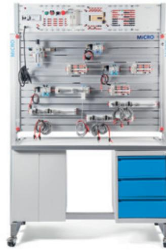
PANEL DIDACTO NEU PARA EJERCICIOS CON COMPONENTES Y LÓGICA NEUMÁTICA. PERMITE CAPACITAR EN FORMA PRÁCTICA Y METÓDICA EN LA TÉCNICA DE MANDO NEUMÁTICO, LA CUAL ES DE AMPLIA APLICACIÓN EN LAS AUTOMATIZACIONES INDUSTRIALES.
